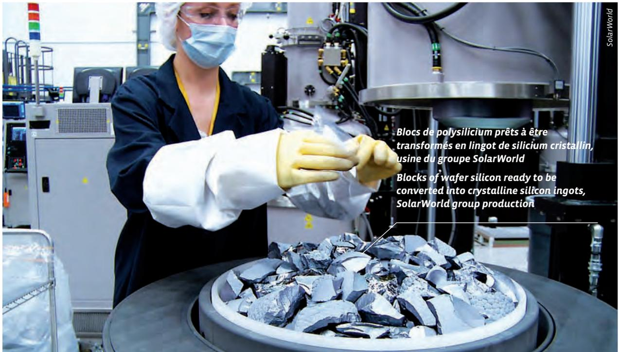
Blocs de polysilicium prêts à être transformés en lingot de silicium cristallin, usine du groupe SolarWorld
