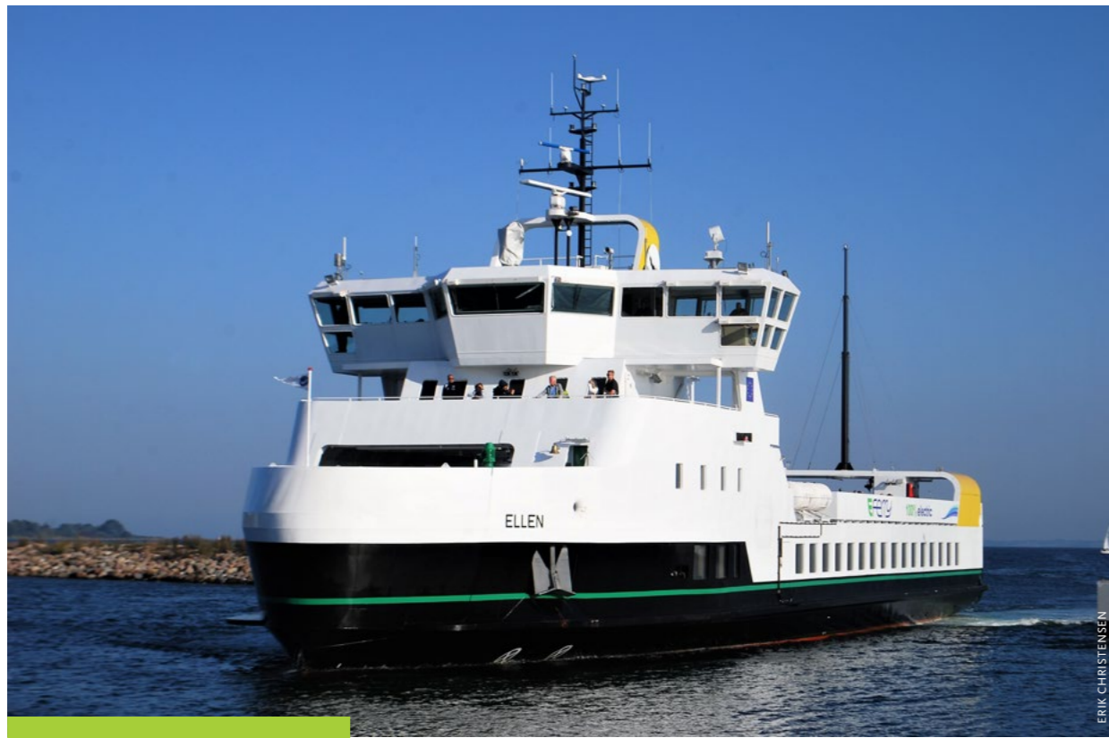
Au Danemark, le projet Ellen permet depuis 2019 d'alimenter en électricité renouvelable un ferry électrique, remplaçant d'un ancien ferry diesel.
