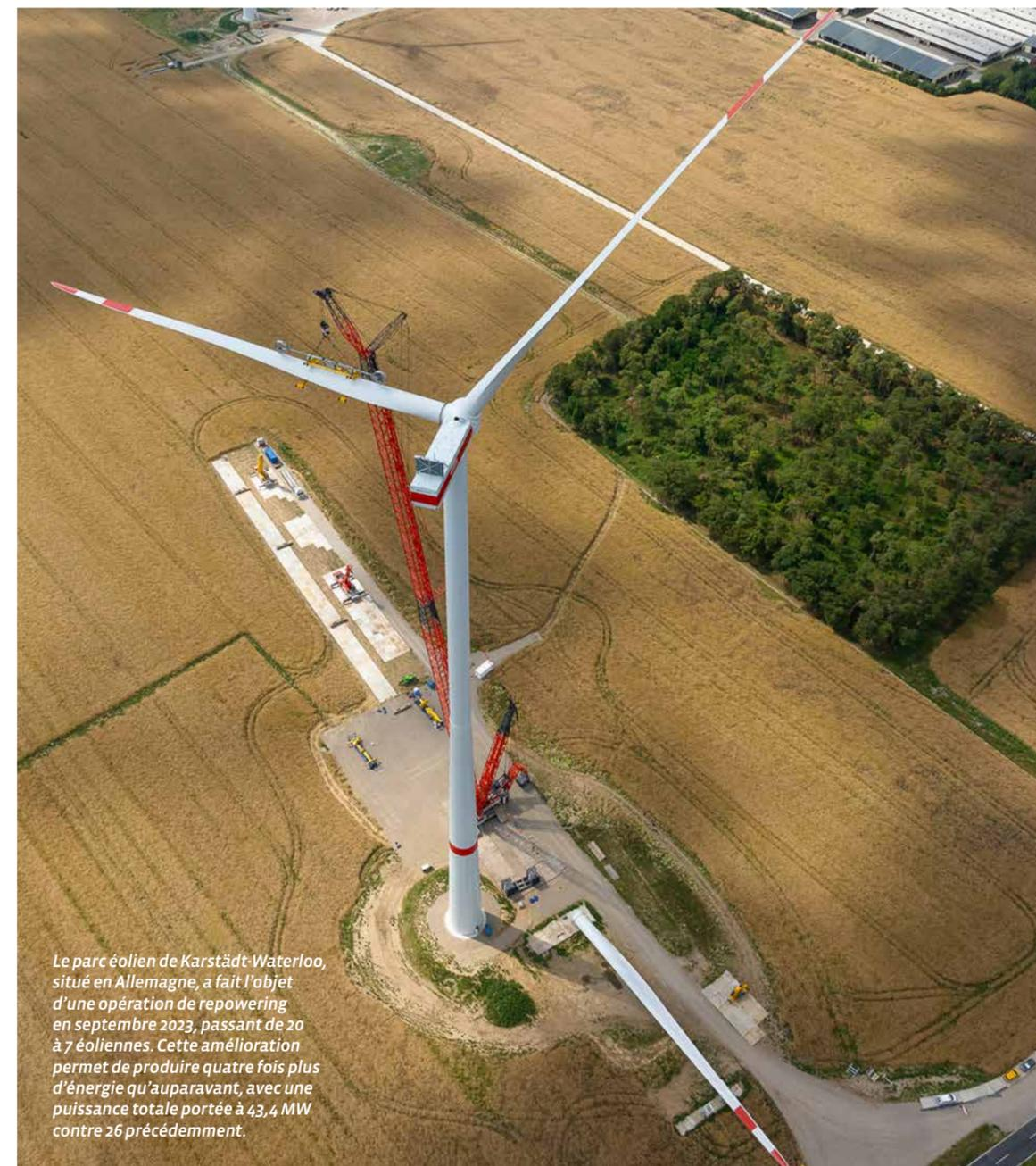
Le parc éolien de Karstädt-Waterloo, situé en Allemagne, a fait l'objet d'une opération de repowering en septembre 2023, passant de 20 à 7 éoliennes. Cette amélioration permet de produire quatre fois plus d'énergie qu'auparavant, avec une puissance totale portée à 43,4 MW contre 26 précédemment.
